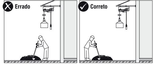
Fig. 9 - No permitir personas abajo del área de desplazamiento de la grúa
